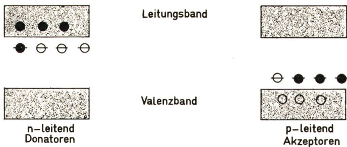
Fig. 8 Das Bändermodell des dotierten Halbleiters
