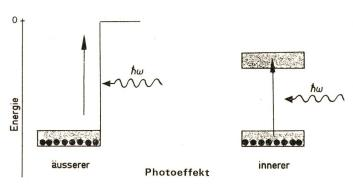
Fig. 16 Der äussere und innere Photoeffekt im Bändermodell
