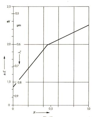
Fig. 13 Der Bandabstand  $\Delta E$  beim Mischkristall GaAs  $_{1-x}\mathbf{P}_{_{X}}$  als Funktion des Mischungsverhältnisses  $\varkappa$  [3]
