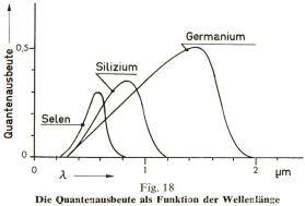
Die Quantenausbeute als Funktion der Wellenlänge für verschiedene Photoelemente
