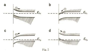
Möglichkeiten der Bandkantenverformung bei Metall-Halbleiter-Übergang
