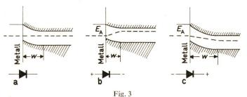
Einfluss der Vorspannung auf die Sperrschichtweiten einer Schottky-Diode
