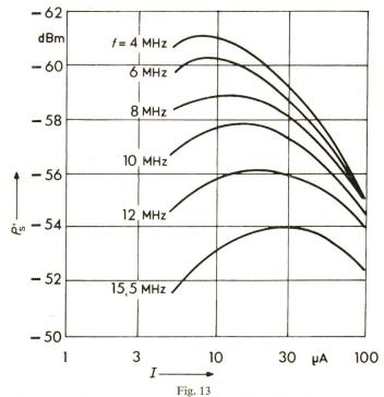
Empfindlichkeit eines mit einer Schottky-Diode bestückten Videodetektors vom Diodenvorstrom (HPA 2755) für verschiedene Frequenzen
