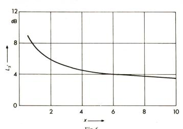
Fig. 6 Konversionsverluste in Abhängigkeit vom Kennlinienexponent x
