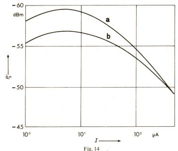
Detektorempfindlichkeit in Abhängigkeit vom Diodenstrom
