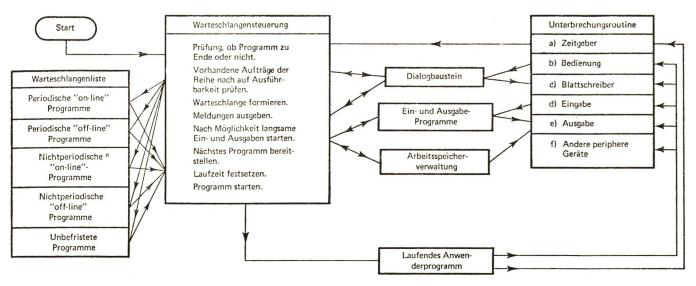
Fig. 1 Blockdiagramm des Betriebssystems
