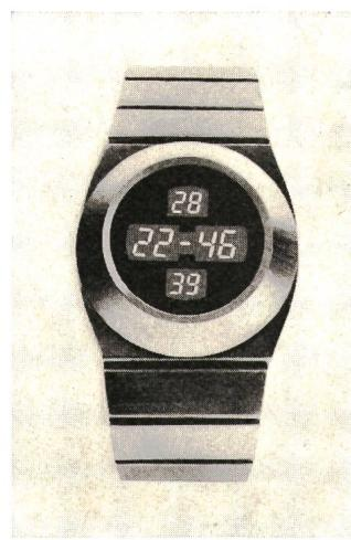
1,35 V mit einer Gangdauer von einem Jahr gespeiste Uhr zeigt nicht nur die Stunde, Minute und Sekunde, sondern auch das Datum an.
