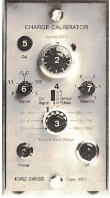
Kalibrierpunkt (Anzahl mechanische Einheiten, zum Beispiel 200 bar) wird gewählt und das entsprechende Kalibriersignal wird auf Knopfdruck (oder fernbetätigt) abgegeben. Es können fünf verschiedene Signalformen gewählt werden und das Gerät kann auf den Eingang von 5 Messkanälen umgeschaltet werden.
