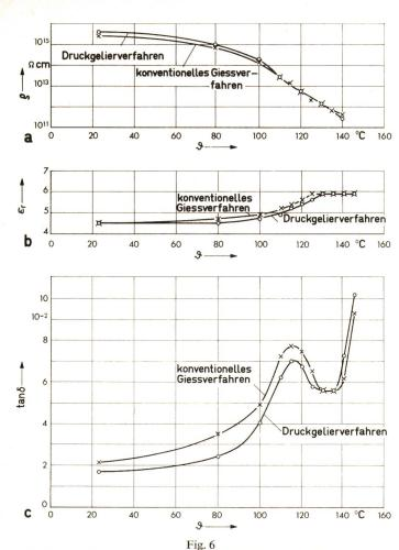
Einfluss des Herstellungsverfahrens auf die dielektrischen Eigenschaften a spezifischer Durchgangswiderstand  $\varrho$  in Abhängigkeit von der Temperatur  $\vartheta$
