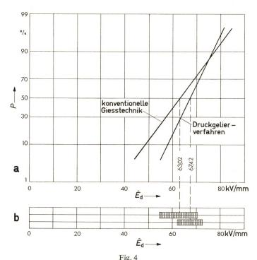
Einfluss des Herstellungsverfahrens auf die Durchschlagfestigkeit  $\hat{E}_{\rm d}$  a Verteilungsfunktionen für eine Stichprobe von 10 Prüfkörpern je Giessverfahren
