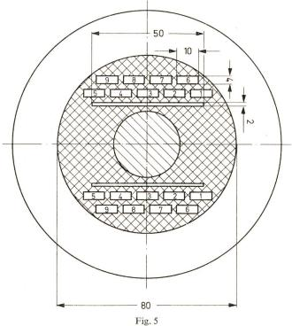
Lage der Proben für die Untersuchung der dielektrischen und der mechanischen Eigenschaften in den Prüfkörpern
