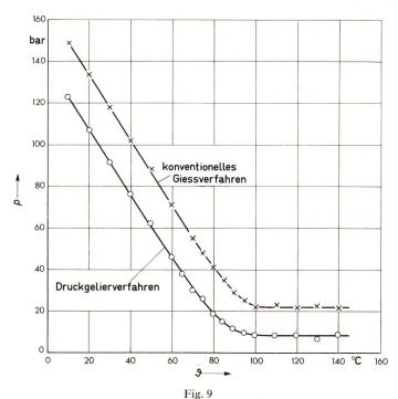
Einfluss des Herstellungsverfahrens auf den Schwindungsdruck p in Abhängigkeit von der Temperatur 3
