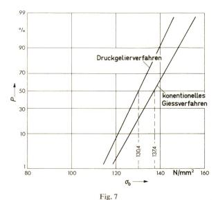
Einfluss des Herstellungsverfahrens auf die Biegefestigkeit σ<sub>b</sub> Verteilungsfunktionen für eine Stichprobe von 36 Probestäben aus einem Prüfkörper pro Giessverfahren
