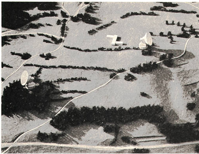
Fig. 9 Modellaufnahme des Stationsgeländes mit 2 Antennen für den Verkehr nach Westen und Osten
