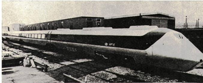
ten technischen Erkenntnisse verwirklicht. Mit der neu entwickelten Achsenaufhängung haben die Triebzüge auf den vorhandenen Gleisen auch bei der höchsten Konstruktionsgeschwindigkeit ausgezeichnete Laufeigenschaften und verursachen einen geringeren Verschleiss der Schienen als herkömmliche Züge.
