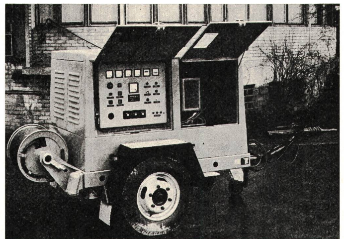
Fig. 2 Mobiles Notstromaggregat von 20 kVA
