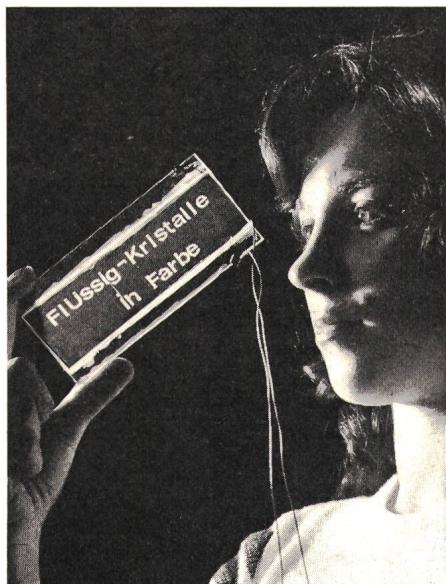
kompakt aufgebaut werden kann. In den *Siemens*-Laboratorien hat man nun ein Anzeigemittel entwickelt, das diese Forderungen weitgehend erfüllt: sogenannte Flüssigkristallanzeigen.
