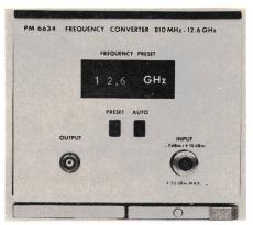
Frequenzmischung. Der erlaubte maximale Hub bei frequenzmodulierten Signalen beträgt 200 MHz.
