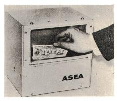
Schweiz. Das Gerät testet Banknoten sowohl optisch als auch mechanisch ab. Fälschungen werden mit hoher Sicherheit erkannt, während die normalen Abweichungen zwischen einzelnen Geldscheinen oder Scheine, die bis zu einem gewissen Grad verschmutzt oder abgegriffen sind, angenommen werden.
