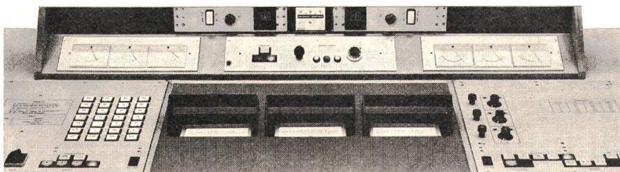
Diese neue wattmetrische Station erlaubt die Zählereichung mit außerordentlich hoher Genauigkeit, z. B. für Hochpräzisionszähler der Klasse IEC 0,5.
