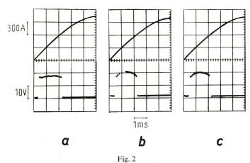
Einschaltvorgang unter Prüfstrom  $\hat{i} = 1000$  A,  $n_{\rm S} = 1000$  a zehnte Schaltung,  $F_{\rm S} = 58,8$  N b fünfhundertste Schaltung,  $F_{\rm S} = 79,5$  N c eintausendste Schaltung,  $F_{\rm S} = 167$  N
