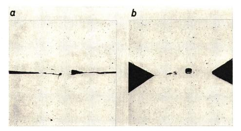
sichtlich, dass sich die verdrängte bzw. verspritzte Schmelze kranzförmig an den Rändern der Lichtbogenfusspunktgebiete ablagert und strahlenförmig von den Kontaktstückoberflächen absteht.
