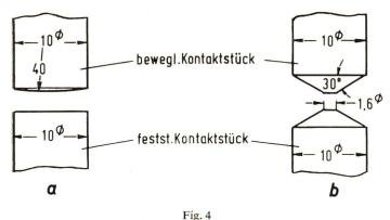
Kontaktstückanordnung im Prüfschalter
