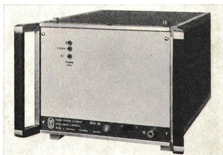
**Quick-Star.** Bohrmaschinen für gedruckte Schaltungen gibt es in letzter Zeit in steigender Anzahl, die sich in Preis und Handlichkeit deutlich unterscheiden. Quick-Star nennt sich eine neue Entwicklung, wobei das elektronische Steuergerät und die mechanische Bohreinheit der Flexibilität und Handlichkeit halber ge-
