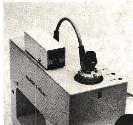
trennt sind. Die Technischen Daten sind: Bohrer 0,2...3,0 mm  $\varnothing$ , Ausladung 180 mm, Drehzahl stufenlos 10 000...50 000 U./min, 3-Phasen-Stromversorgung für niedrigste Oberwellenerzeugung im Motor mit damit verbundener erhöhter Lebensdauer der Motors, Hubbetätigungen durch Handhebel manuell oder Fusspedal mit stufenlos elektronisch einstellbarer Absenkgeschwindigkeit der Spindel, beleuchtete Fadenkreuzoptik und zusätzliche Beleuchtung zum Arbeiten ohne Optik, Lochzähler.
