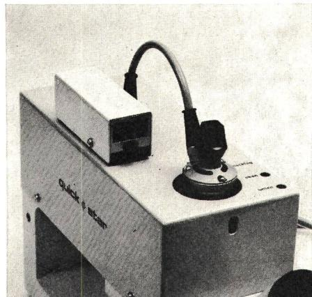
trennt sind. Die Technischen Daten sind: Bohrer 0,2...3,0 mm  $\varnothing$ , Ausladung 180 mm, Drehzahl stufenlos 10 000...50 000 U./min, 3-Phasen-Stromversorgung für niedrigste Oberwellenerzeugung im Motor mit damit verbundener erhöhter Lebensdauer der Motors, Hubbetätigungen durch Handhebel manuell oder Fußpedal mit stufenlos elektronisch einstellbarer Absenkgeschwindigkeit der Spindel, beleuchtete Fadenkreuzoptik und zusätzliche Beleuchtung zum Arbeiten ohne Optik, Lochzählner.
