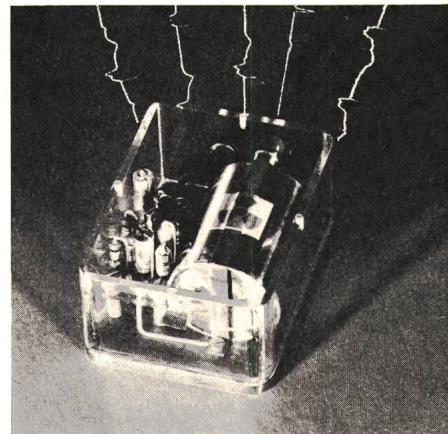
Menge wird in einer Kugel von 10 Millimeter Durchmesser untergebracht. Die beim radioaktiven Zerfall des Plutoniums frei werdende Energie führt zur Erwärmung der Kapsel auf etwa  $100^\circ\text{C}$ . Diese Wärmeenergie wird mit Thermoelementen in elektrische Energie umgewandelt.
