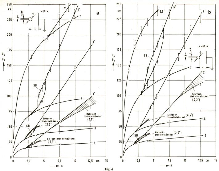
Anfang-, Durchschlagspannung und Existenzbereiche der Stehstielbüschel einer Kugel-Platte-Funkenstrecke mit r=0.7 cm Kugelradius in Abhängigkeit von der Schlagweite bei verschiedenen relativen Luftdichten
