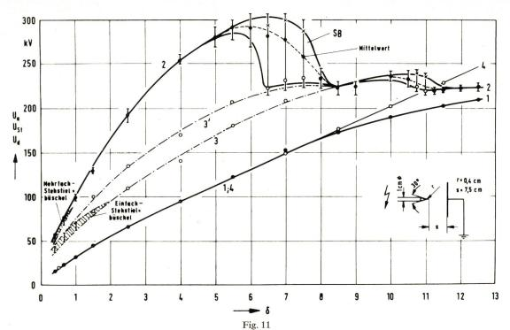
Anfang-, Stielbüscheleinsetz- und Durchschlagsspannung einer Stab-Platte-Funkenstrecke mit  $r=0.4~{\rm cm}$  Abrundungsradius in Abhängigkeit von der relativen Luftdichte  $\delta$  bei einer Schlagweite von  $s=7.5~{\rm cm}$
