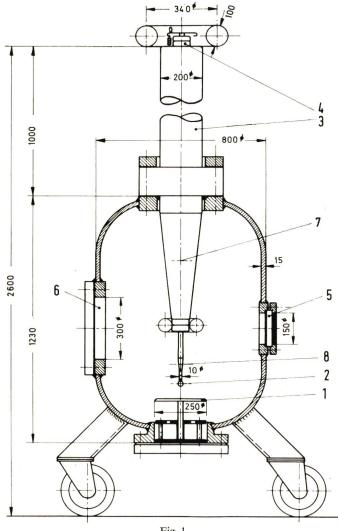
Fig. 1 Versuchsgefäss Masse in mm
