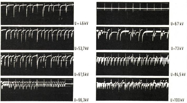
Fig. 10 Impulsförmiger Anteil des Vorentladungsstromes U in einer Stab-Platte-Funkenstrecke  $\delta=I;\ r=0,4\ {\rm cm};\ s=7,5\ {\rm cm};$   $x:100\ \mu{\rm s/cm};\ y:10\ {\rm mV/cm}$  (an  $60\ \Omega$ )
