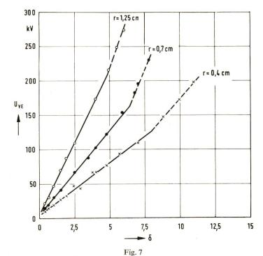
Anfangsspannung  $U_{\mathrm{VE}}=U_{\mathrm{a}}$   $(s_{\mathrm{VE}})$  beim Auftreten stabiler negativer Vorentladungen in Kugel-Platte-Funkenstrecken als Funktion der relativen Luftdichte  $\delta$  bei verschiedenen Krümmungsradien r
