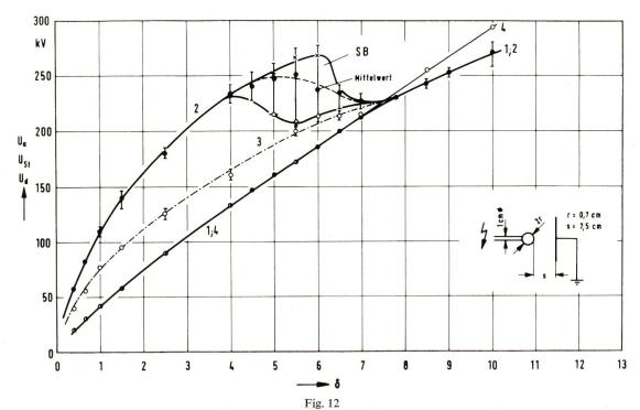
Anfang-, Stielbüscheleinsetz- und Durchschlagspannung einer Kugel-Platte-Funkenstrecke mit r=0.7 cm Kugelradius in Abhängigkeit von der relativen Luftdichte  $\delta$  bei einer Schlagweite von s=7.5 cm
