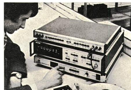
hungweise Multimeter, die alle vom selben Grundgerät aufgebaut sind. Durch Austauschen von Steckkarten sind die Funktionen DC, AC, Ohm und Ratio möglich.
