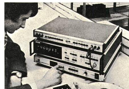
hungweise Multimeter, die alle vom selben Grundgerät aufgebaut sind. Durch Austauschen von Steckkarten sind die Funktionen DC, AC, Ohm und Ratio möglich.
