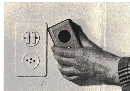
und zeigt durch Veränderung des Kontrolltones über den eingebauten Lautsprecher an, wo sich die Leitungen in einer Wand befinden. Der Verlauf der Leitungen, Stahlarmierungen usw. kann genau verfolgt werden.
