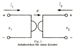
$V_1=Ri_2;\ V_2=Ri_1$   $V_1$  Eingangsspannung;  $V_2$  Ausgangsspannung;  $i_1$  Eingangsstrom; i2 Ausgangsstrom; R Übertragungsimpedanz
