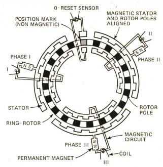
Fig. 1 Prinzip des Antriebs des Ringrotors
