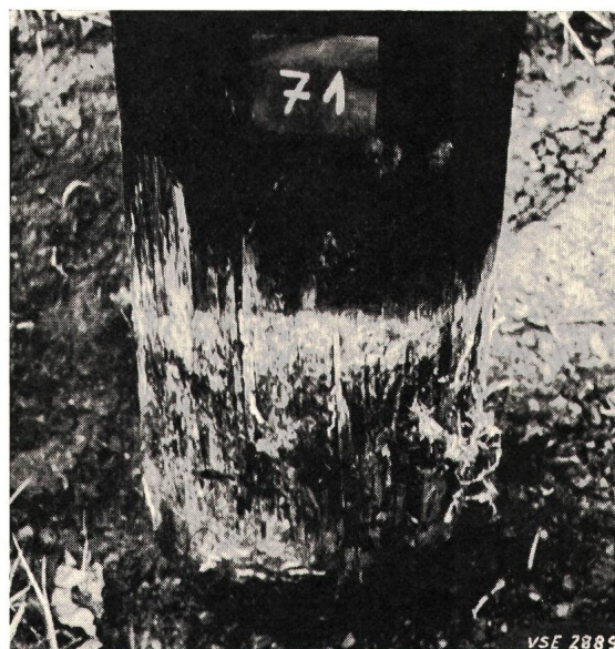
Fig. 1 Leitungsstange mit Kupfersulfat imprägniert und in der Bodenzone durch Poria vaillantii vermorscht. Vorn und rechts an der Stange für diesen Pilz charakteristische weisse Mycelstränge.
