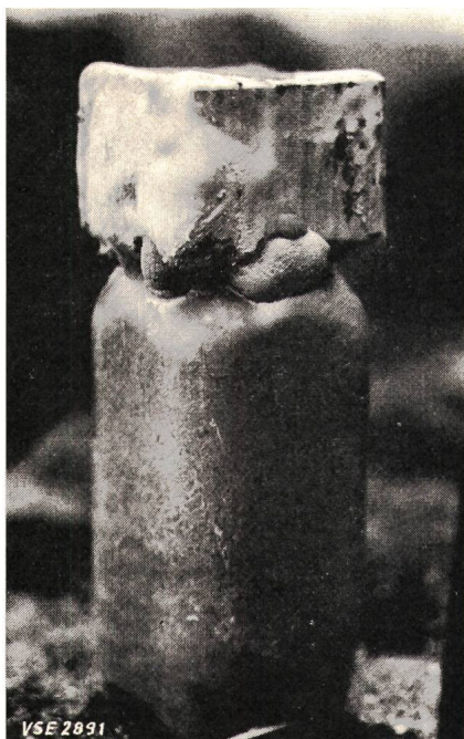
Fig. 3 Kultur von Poria placenta auf mit Nährstoffen ange- reichertem Sägemehl mit Fruchtkörperbildung an auf- gesetztem Holzblock.
