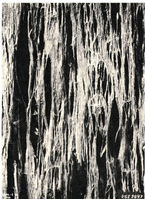
Fig. 11 Faserige Nassfäule wie in Abb. 10 gezeigt. Das Holz weist faserige Zersetzung mit Kavernenbildung auf.
