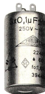
ENTSTÖRUNG – Kompakt-Ausführung – X oder Y oder XY Kapazitäten nach SEV, VDE-Vorschriften und anderen Ländern Klimakategorie 25/85/21
