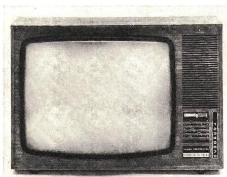
blitzschnell und sind gegen Störungen wie zum Beispiel Hochspannungsüberschläge unempfindlich. – 66-cm-Rechteckbildröhre in 110°-Weitwinkeltechnik.
