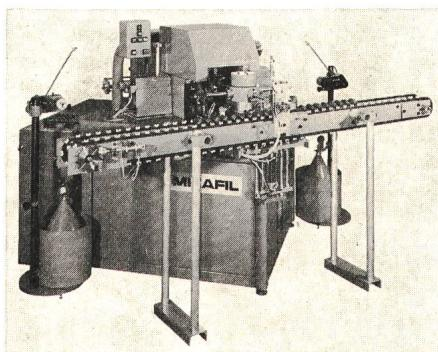
Diese wickelt und legt die Anschlussdrähte vollautomatisch in die Kollektorschlitze. Die Rotoren werden von einem Kettenförderband über ein Drehkreuz in die Wickelposition gebracht und nach dem Bewickeln wieder auf das Band abgegeben. Die elektronische Folgesteuierung sorgt für das störungsfreie Funktionieren der Maschine.
