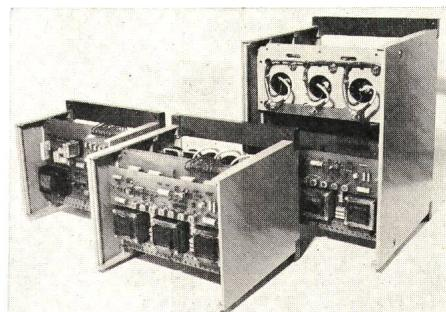
Motorerregung. Die Verluste dieser Thyristorgeräte sind so gering, dass der Wirkungsgrad des Antriebes praktisch dem Motorwirkungsgrad entspricht. Der thyristorgespeiste Gleichstromantrieb hat sich hervorragend bewährt.
