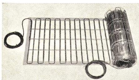
(Dauer-Temperatur-Beständigkeit 205 °C) und einem Mantel aus wärmebeständigem PVC. Sie sind in einer wasserdichten Verbindungs-Muffe aus gespritztem PVC mit den Kaltleitern (feindrähtig, Isolierung und Mantel aus PVC) verbunden. Eine Leistung von 10 W/m lässt Heizleitungstemperaturen von ca. 50 °C erwarten.
