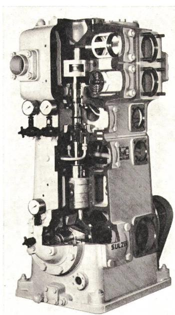
Leistungen bis zu 2,4 Mill. kcal/h pro Kompressor, bezogen auf Verdampfungs-temperatur -10 °C und Kondensations-temperatur +25 °C. Sie sind bekannt für ihre Zuverlässigkeit im Betrieb und für lange Lebensdauer. Die neuesten Konstruktionen erlauben es, Ansaugtemperaturen bis -160 °C zu fahren.
