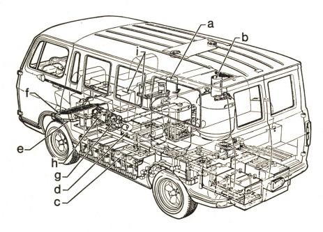
Kleinbus «Electrovan» der General Motors Co. mit  $32\text{-kW-H}_2/O_2\text{-Batterie}$
