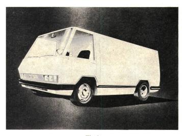
Fig. 1 Elektrotransporter der MBB
