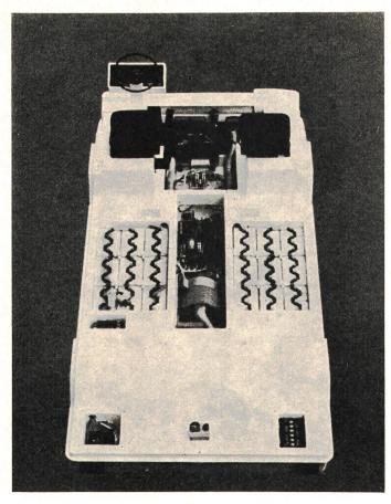
Fig. 2 Chassis der MBB-Elektrotransporter
