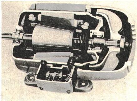
Federdruckbremse nach dem Verschiebeläuferprinzip sind. Sie werden als Käfig-, Schleifring- und Gleichstrommotor ausgeführt.
