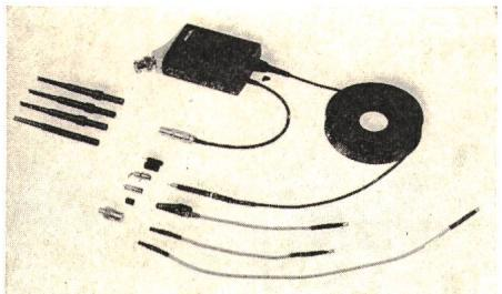
Eine neue Mikro-Miniatursonde von Philips löst nun diese Probleme. Die Sonde besteht aus einem Gehäuse (in dem sich die aktive Kompensationsschaltung befindet), einem 2,5 m langen, leichten flexiblen Kabel sowie speziellen Adapters, mit denen man die Sonde z. B. kurzschlussfrei an die Anschlußstifte eines «dual in line»-Gehäuses oder an «mini wire wrap»-Stifte anschliessen kann.
