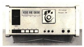
Fig. 1 Mobiler Empfänger für die elektronische Verkehrsmesseinrichtung VM 70
