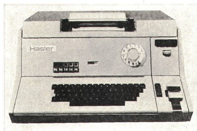
Fig. 3 Elektronisch gesteuerter Fernschreiber SP 20
