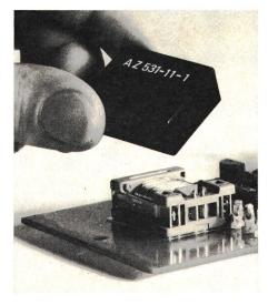
erfolgt über zwei Wicklungen mit Mittelanzapfung (Anzugserregung ca. 140 AW, Abwurferregung ca. 40 AW). Die Schaltleistung beträgt 30 W bei einer Schaltspannung von max. 30 V und einem Schaltstrom von max. 1 A. Das neue Relais eignet sich besonders zum Einsatz in der Datenverarbeitung und in Werkzeugmaschinensteuerungen. Es ist weitgehend stoss- und schüttelfest und daher auch für transportable Geräte verwendbar.
