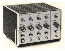
MHz mit einstellbarer Verzögerung, Dauer und Amplitude der Impulse. Zusätzliche Möglichkeiten eröffnen externe Triggerung, extern ansteuerbare Torschaltung zur Erzeugung definierter Impulsgruppen, Einzelimpulsauslösung, Doppelimpulsbetrieb und ein Synchronisierausgang.
