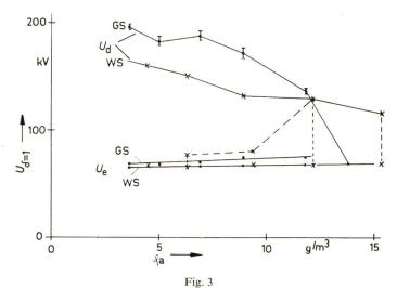
Einfluss der absoluten Feuchtigkeit  $\varphi_a$  auf die Durchschlagspannung  $U_{\rm d}$  einer 10-cm-Stab—Platte-Funkenstrecke
