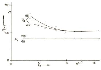
Fig. 4 Einfluss der absoluten Feuchtigkeit  $\varphi_{\rm a}$  auf die Durchschlagspannung  $U_{\rm d}$  einer Zylinderfunkenstrecke Aussenzylinder D=40 cm, Innenleiter d=10 mm, Länge des Aussenzylinders: 90 cm Weitere Bezeichnungen siehe Fig. 1
