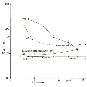
Fig. 2 Einfluss der absoluten Feuchtigkeit  $\varphi_{\rm a}$  auf die Durchschlagspannung  $U_{\rm d}$  einer 20-cm-Stab—Platte-Funkenstrecke Elektrodenform: stumpf mit 2 mm Kantenradius
