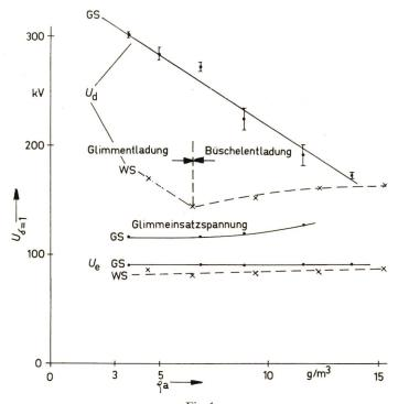
Fig. 1 Einfluss der absoluten Feuchtigkeit  $\varphi_{\rm a}$  auf die Durchschlagspannung  $U_{\rm d}$  einer 30-cm-Stab—Platte-Funkenstrecke
