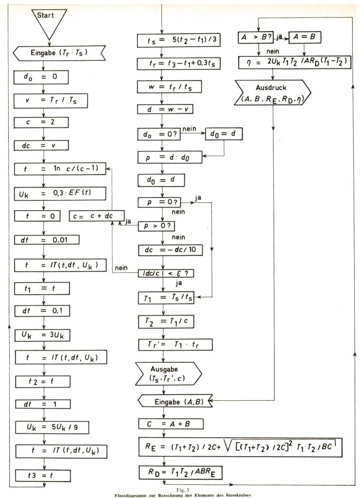
UP EF (t) Lösung von Gl. (6); UP  $IT(t, dt, U_k)$  numerische Lösung der Gl.  $EF(t) = U_k$  nach 2.1.2
