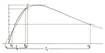
Fig. 2 Zeitlicher Verlauf und Zeitkennwerte der Stoßspannung  $T_{\rm S}$  Stirnzeit;  $T_{\rm T}$  Rückenhalbwertszeit; t Zeit
