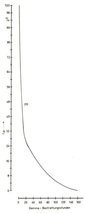
Fig.~10 Relative Lichtdurchlässigkeit für  $\lambda=450$  nm des Gamma-bestrahlten Silikatglases (Massivopal), bezogen auf den unbestrahlten Prüfling gleich 100 %
