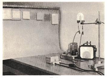
Fig. 1 UV-Strahlenquelle im Betrieb mit Prüflingen
