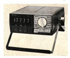
nauen Messung von Gleich- und Wechselspannung, Gleich- und Wechselstrom, sowie Widerstand. Das Modell 1242 erfüllt dank hoher Genauigkeit und erweitertem Messumfang die stetig steigenden Anforderungen in der Praxis. Seine wichtigsten Daten sind:
