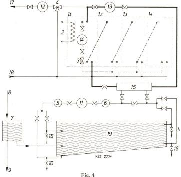
Prinzipschaltung für die Beckenwassererwärmung mittels bestehendem elektrischen Zentralspeicher für die Raumheizung
