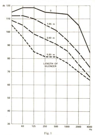
Schallpegel (dB) am Auspuff einer 30-MW-Gasturbinenanlage in Blockbauweise ohne und mit um je ein Drittel verstärkter Schalldämmung
