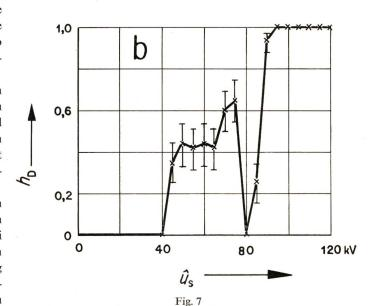
Stoßspannungs-Beanspruchungen als Folgen-Beanspruchung einer gasisolierten koaxialen Zylinder-Funkenstrecke
