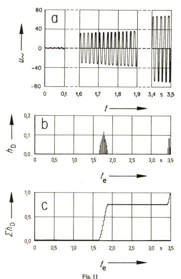
Beanspruchung einer gasisolierten koaxialen Zylinder-Funkenstrecke durch eine Wechselspannung mit zeitlich ansteigendem Scheitelwert
