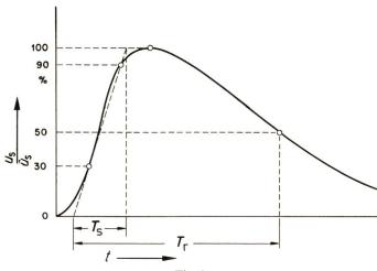
Fig. 6 Zeitlinienbild einer Stoßspannung mit der Festlegung der Kenngrössen  $T_{\rm S}$  Stirnzeit;  $T_{\rm r}$  Rückenhalbwertzeit
