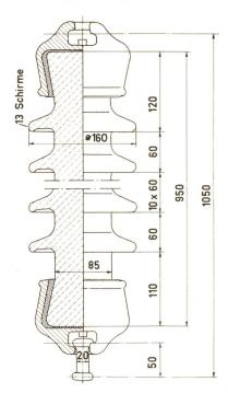
Fig. 2 Langstab-Isolator mit 13 Schirmen Typ VKL 85/13
