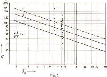
Vergleich des im Netzbetrieb überschlagenen Langstabisolators vom Typ VKL 85/13 mit dem Isolator vom Typ VKL 75/14
