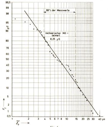
Fig. 4 Verteilung der an der Schirmoberseite gemessenen Schichtleitfähigkeiten für die vier Isolatoren
