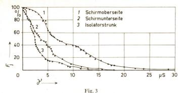
Anteile der Schichtleitfähigkeiten auf den Isolatoren gruppiert nach Niederschlagsstellen an der Oberfläche  $F_1$  Summenhäufigkeit;  $\gamma$  Schichtleitfähigkeit
