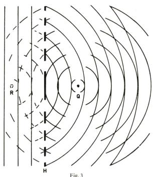
Bei Beleuchtung der Fresnel-Zonenplatte mit einer ebenen Welle werden zwei Bilder erzeugt: R, das virtuelle Bild, und Q, das reelle Bild
