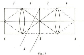
Anordnung für die kohärente Raumfrequenzfilterung 1 Input; 2 Filter; 3 Output; 4 Referenz
