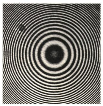
Fig. 2 Vergrösserter Ausschnitt einer Fresnel-Zonenplatte
