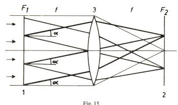
Schematische Darstellung der Apparatur, mit welcher das Raumfrequenzspektrum einer Transparenz (Diapositiv) erzeugt werden kann Das Diapositiv parallel verlassende Strahlen vereinigen sich in einem Punkt
