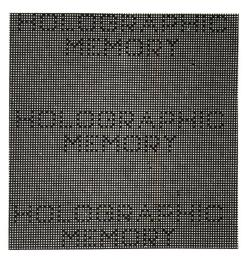
Fig. 8 Testraster für einen holographischen Speicher
