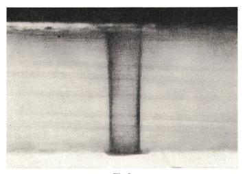
Fig. 8 Längsschnitt durch ein Bohrloch in Saphir (Bohrdurchmesser ca. 40  $\mu$ m) Aufnahme in Immersionsflüssigkeit
