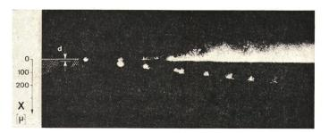
Fig. 6 Zeitlicher Ablauf des Bohrvorganges mit vergrösserter Zeitauflösung zur Demonstration des elementweisen Fortschreitens der Bohrung
