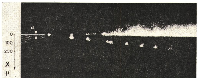
Fig. 6 Zeitlicher Ablauf des Bohrvorganges mit vergrößerter Zeitauflösung zur Demonstration des elementweisen Fortschreitens der Bohrung
