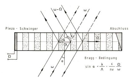
Winkel ist abhängig von der Ultraschallwellenlänge A, bzw. Schallfrequenz  $\Omega$ , gemäss
