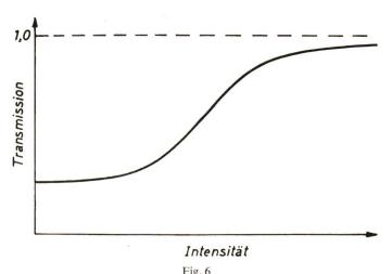
Intensitätsabhängige Transmission eines ausbleichbaren Schalters
