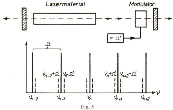
Laser mit internem Modulator zur Phasenkopplung der Moden mit dem Frequenzabstand  $\Omega$  (mode-locking)
