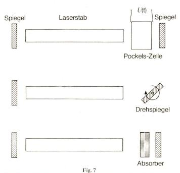
Verschiedene Methoden zur Erzeugung von Riesenimpulsen mit Q-switching
