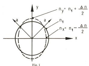
index  $n_x = n_1$  für Polarisation in x-Richtung ist verschieden vom Brechungsindex  $n_3$  für Polarisation in z-Richtung. Das elektrische Feld E ändert  $n_x$  um  $\Delta n/2$  entsprechend Gl. (1). Für die Phasenänderung  $\Delta \Phi$  erhält man unter Berücksichtigung der verschiedenen Kristallängen l für das E-Feld und d für den Lichtweg:
