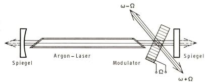
Auskopplungsmodulation mit einem internen Bragg-Ultraschall-Modulator
