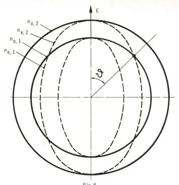
Fig. 8 Phase-matching Winkel  $\theta$  für 2. Harmonische in doppelbrechenden Kristallen. Winkelabhängigkeit der Brechungsindizes
