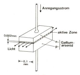
Fig. 17 Der Gallium-Arsenid-Laser als Beispiel für die Halbleiter-Laser
