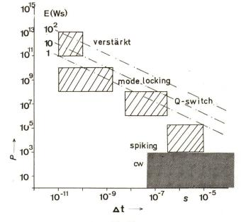
Fig. 16 Pulsleistung und Pulsdauer von Festkörper-Lasern in den verschiedenen Betriehsarten
