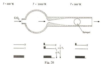
Das gasdynamische Anregungsprinzip am Beispiel des CO<sub>2</sub>-Lasers
