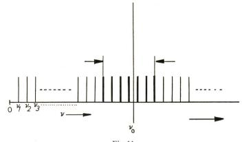
Von diesen gelangen nur diejenigen zur Selbsterregung, die im Bereich  $\nu_0$  der Mittenfrequenz des Laserverstärkers liegen
