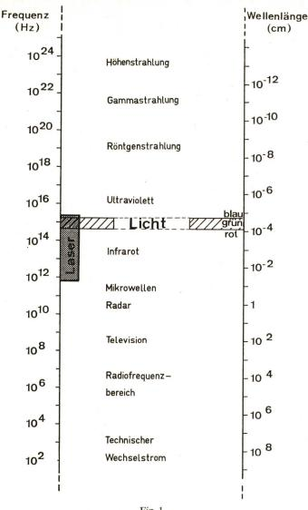
Fig. 1 Das Spektrum der elektromagnetischen Wellen
