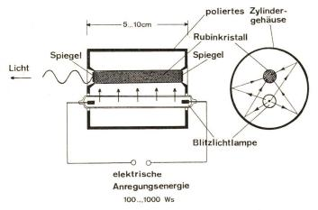
Fig. 14 Prinzipieller Aufbau eines gepulsten Festkörper-Lasers
