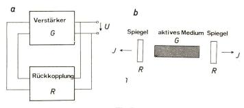
Fig. 7 Das Rückkopplungsprinzip beim Hochfrequenzsender (a) und beim Laseroszillator (b)
