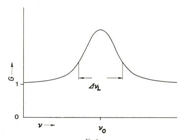
Fig. 6 Frequenzabhängigkeit des Verstärkungsfaktors eines aktiven Mediums G Verstärkungsfaktor;  $\nu$  Frequenz;  $\nu_0$  Mittenfrequenz des aktiven Mediums;  $\Delta\nu_L$  Bandbreite
