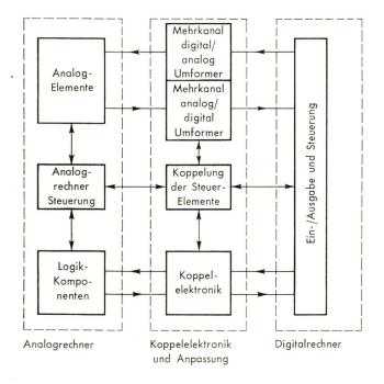
Koppelelektronik dient zur Umwandlung und Anpassung digitaler Daten in entsprechende analoge Signale und umgekehrt.
