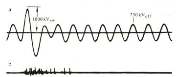
Fig. 2 **Prüfung eines Leistungstransformators**a Prüfspannung
