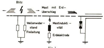
Ersatzschaltung bei einem Blitzschlag in die Freileitung in mittlerem Abstand vom Kabelverschluss
