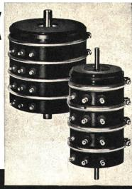
NOVOTECHNIK-Präzisions-Ringpotentiometer verschiedener Baugrößen bieten außergewöhnlich hohe Auflösung (1/5000) und hohe Genauigkeit (Linearitäten bis  $\pm$  0,1 %). Sie sind zu Sätzen stapelbar, leicht justierbar und werden in den Widerstandswerten 250  $\Omega$  bis 100 k $\Omega$  auch mit Anzapfungen geliefert.
