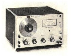
lationskennlinie erzielt. Über einen Eingang lässt sich die gewünschte Modulationsspannung mit einer Frequenz zwischen 0 und 1,2 MHz dem Gerät zuführen.
