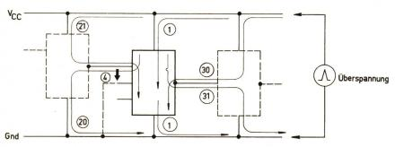
Fig. 1 Überspannungseinwirkung auf ein NAND-Tor  $V_{\rm CC}$  Speiseleiter; Gnd Masse
