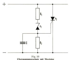
$R_1$  Begrenzungswiderstand des Zenerstroms;  $R_2$  Gitterwiderstand;  $n_2$  Schutzthyristor; C Verzögerungskondensator;  $n_1$  Zenerdiode zur Bestimmung der Schaltschwelle
