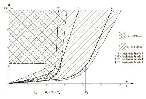
Stössen. Für die Versuche wird HS 1 auf 0 geschaltet. Anschliessend an die Versuche kann auf Stellung 1, 2, 3, 4, die Transfercharakteristik der Tore 1, 2, 3, 4 gemessen werden. Im abgefallenen Zustand (Relais R) wird C auf  $V_{\text{Stoss}}$  aufgeladen. Durch die manuelle Auslösung zieht R für eine gewisse Zeit an. Dabei wird C entladen, das heisst,  $V_{cc}$  praktisch auf  $V_{Stoss}$  angehoben, wobei n<sub>1</sub> sperrt.
