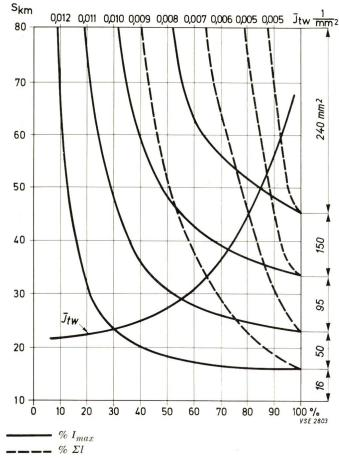
Fig. 1 Auswahl der Leiter aus einem Querschnittssortiment von 16 - 50 - 95 -150 - 240 mm<sup>2</sup>
