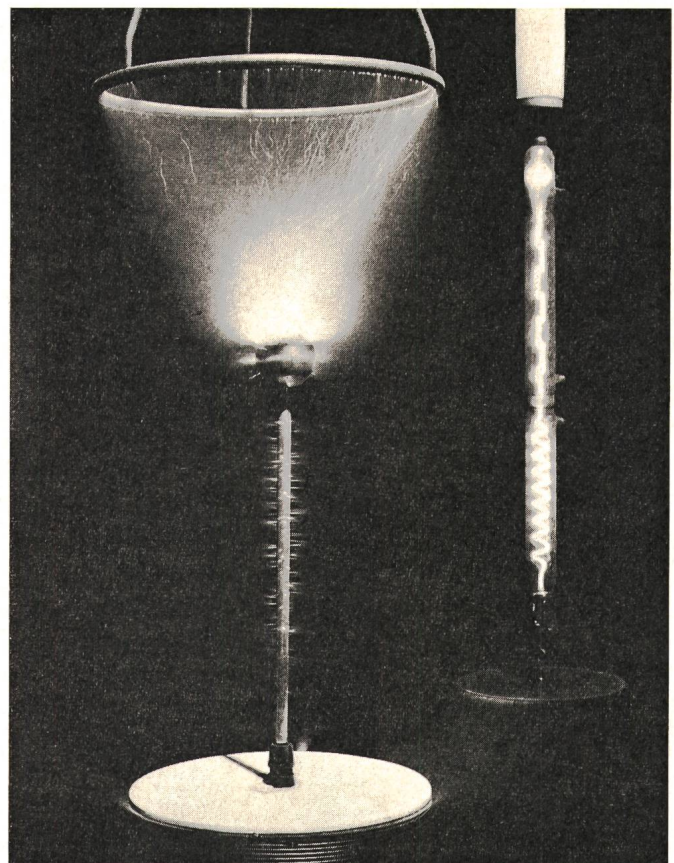
Fig. 15 Hochfrequente Entladungen im Tesla-Kabinett des Deutschen Museums
