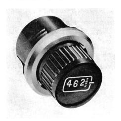
Einstellung und Ablesung von Spannungsund Widerstandswerten. Bemerkenswert sind bei diesem Modell dessen Durchmesser von nur 22,2 mm und der einfache und schnelle Einbau mittels einer «Snap-In»-Mechanik. Die Belastbarkeit bei Raumtemperatur beträgt 1,5 W. Standard-Ausführungen wurden entwickelt von 100  $\Omega$  bis 250  $\Omega$  bei einer Einstellgenauigkeit von max. 0,5 %.
