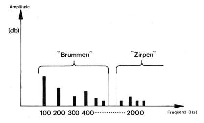
Die Ursache liegt im Eisenkern des Vorschaltgerätes, welcher im Rhythmus der Netzfrequenz ummagnetisiert wird. Diese Ummagnetisierung lässt solche Kräfte im Eisenkern wirken, dass dieser in mechanische Schwingung gerät. Diese Kräfte wirken besonders über dem notwendigen Luftspalt des Eisenkerns.
