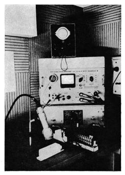
Fig. 6 Anordnung zur Luftschallmessung von Vorschaltgeräten
