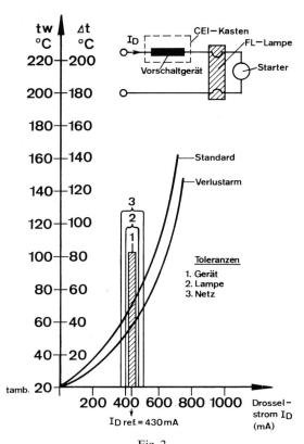
Fig.~2 Wicklungstemperaturen  $t_{\rm W}$  in Abhängigkeit von möglichen Toleranzen des Vorschaltgerätestromes  $I_{\rm D}$  (z. B. einer 40-W-Anordnung), ausgelöst durch Geräte und Lampendaten-Streuungen sowie Netzspannungsänderungen
