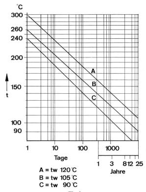
Fig. 3 Lebensdauer von Vorschaltgeräten in Abhängigkeit von einer konstant angelegten Wicklungstemperatur  $t_{\rm w}$ .
