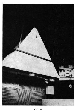
Anordnung zur Geräuschmessung von Vorschaltgeräten, wobei Luftschall, Körperschall und magnetisches Feld in die Messung einbezogen werden
