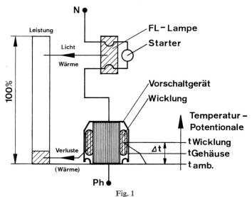
Transformierung der elektrischen Netzanschlussleistung (Ph, N) in Licht,
