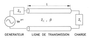
Fig. 2 Schéma équivalent d'un générateur haute fréquence connecté à sa charge  $Z_{\rm c}$  impédance caractéristique  $\beta$  exposant de propagation
