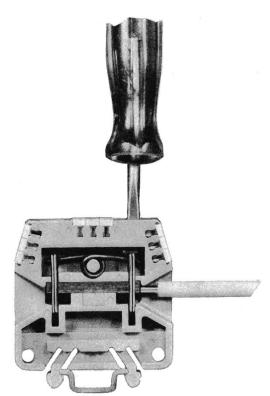
für schnelle und zuverlässige Verbindungen zu Tragschiene nach DIN 46277/2 Isolierkörper aus Polyamid 6.6, Breite 6 mm Wesentliche Zeitersparnis pro Leiteranschluss gegenüber Schraubklemmen durch Wegfall des zeitraubenden Eindrehens der Klemmenschrauben
