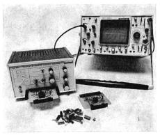
keit lassen sich sehr leicht Fehlerbestimmungen vornehmen, denn das Gerät ermöglicht dann die Messung der wesentlichen statistischen Parameter einer integrierten Schaltung. Einsteckbare Printplatten, die die verschiedenen Fassungen für die integrierten Schaltungen und die notwendigen Frequenzkorrektur-Elemente tragen, ermöglichen eine einfache und schnelle Anpassung an die unterschiedlichen Typen und Anschlussarten.
