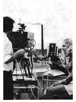
mit dem Oszillographen durchgeführte Auswertung gibt Aufschluss über Entfernung und Dichte der anvisierten Luftfremdstoffe.
